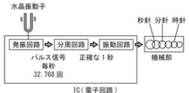
図2 クォーツ時計のしくみ
