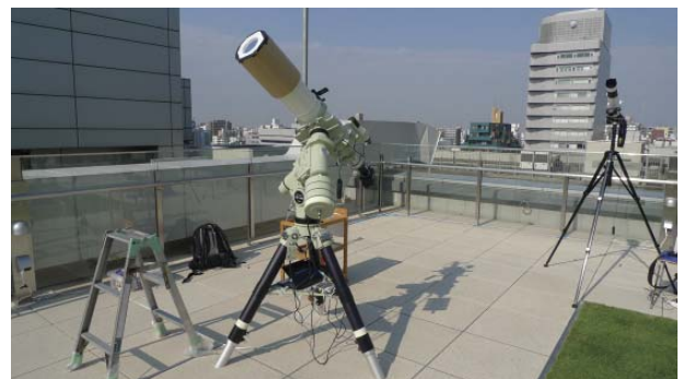
図8 静止画撮影のための15cm屈折望遠鏡 静止画撮影の本命機材。背後に予備機が写っている。
