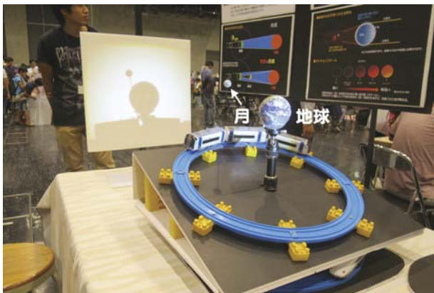
図10 ALCによる科学の祭典での月食の展示 この写真のタイミングでは、手前側にライトがあり地球の影の上を通り過ぎる満月を再現している。下部の台座を回すことで皆既月食も表現できる。
