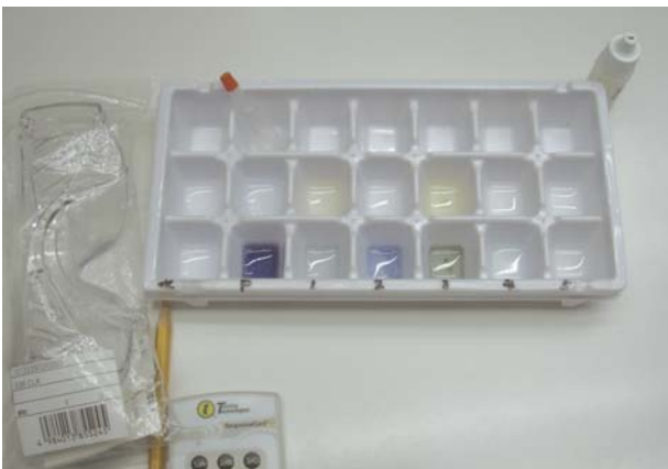
写真2 「リンを調べてみよう」の使用器具：実験には、製氷皿の手前2段を使う。左端は安全眼鏡。
