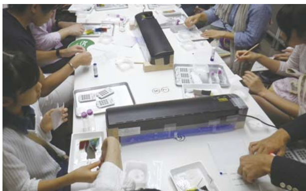
写真4 紫外線の実験。上部照明装置にブラックライトを取り付けたもの。ライトの下に物が置けるように両端でかさ上げしている。長側面両サイドには、UVカットフィルムでカバーを付けた。
