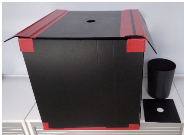
写真5 発光を確認するための暗箱。左は写真撮影に使用。
