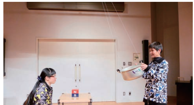
写真2 アルミ鍋の渦電流の実験
